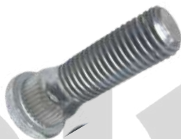
Toyota Saplama Tam Boy: 50 mm Dış Ölçüsü: M12 x 1.50 Dış Boyu: 31 mm Tirtli Çapı: 13 mm Kafa Çapı: 18 mm Hyundai-Era-Accent-Getis-Elentra
