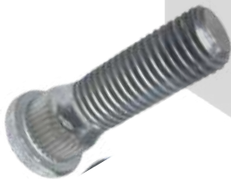
Honda Civic Saplama Tam Boy: 44 mm Dış Ölçüsü: M12 x 1.50 Dış Boyu: 24 mm Tirtli Çapı: 12.5 mm
